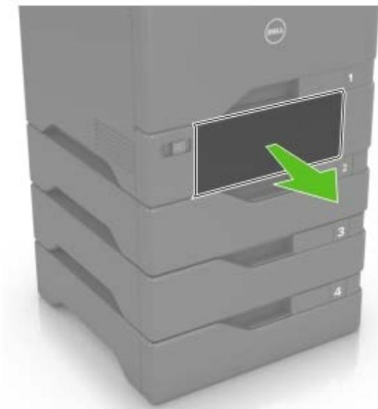
**Advertencia—Posibles daños:** Un sensor dentro de la bandeja opcional se daña fácilmente con la electricidad estática. Toque una superficie metálica antes de retirar el papel atascado en la bandeja.
